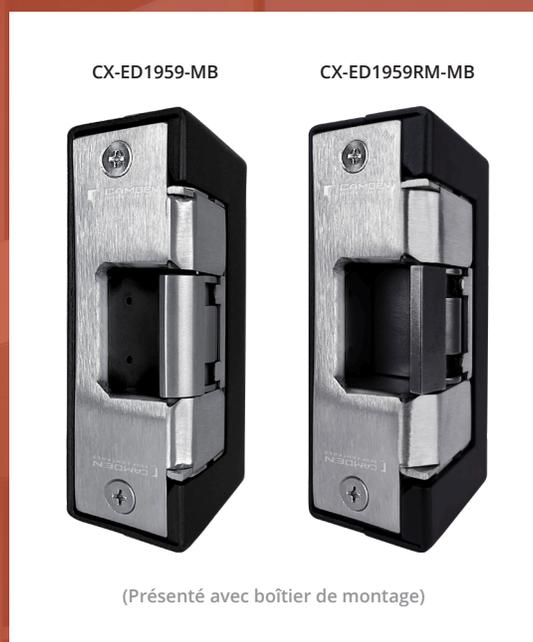
Les gâches extérieures de la série Camden CX-ED1959 sont construites en acier inoxydable robuste avec une plaque frontale carrée ANSI intégrée et une performance de Grade 1. Compatibles avec les serrures à mortaise cylindriques et centrales sans verrous. Les modèles de la série CX-ED1959 comprennent un boîtier de montage en acier peint épais sans frais supplémentaires.
