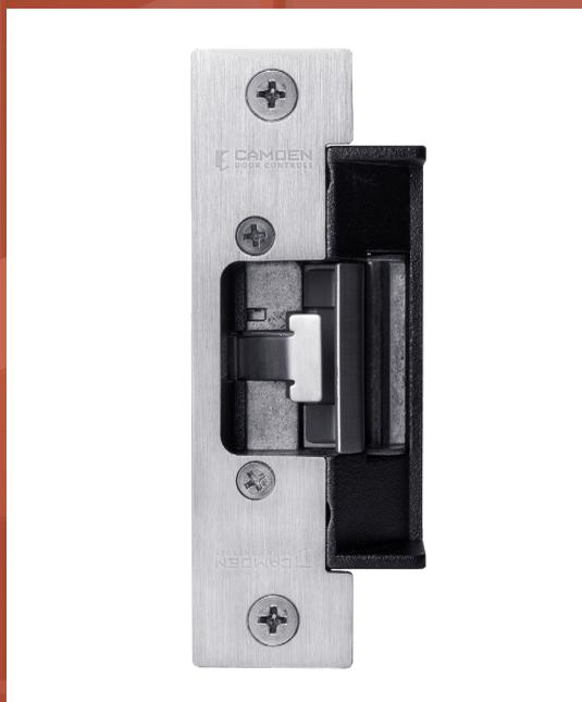
CX-ED1079 (perfil bajo, para proyección de pestillo de 5/8") y CX-ED1079D (profundidad estándar, para proyección de pestillo de 3/4") Los pestillos ANSI 'universales' de grado 1 ofrecen un rendimiento 'universal' con 12/24 V CA/CC seleccionable y funcionamiento a prueba de fallos/protección contra fallos, y tienen ajuste horizontal de placa frontal/cuerpo. Ambos modelos tienen monitoreo de pestillo opcional.
