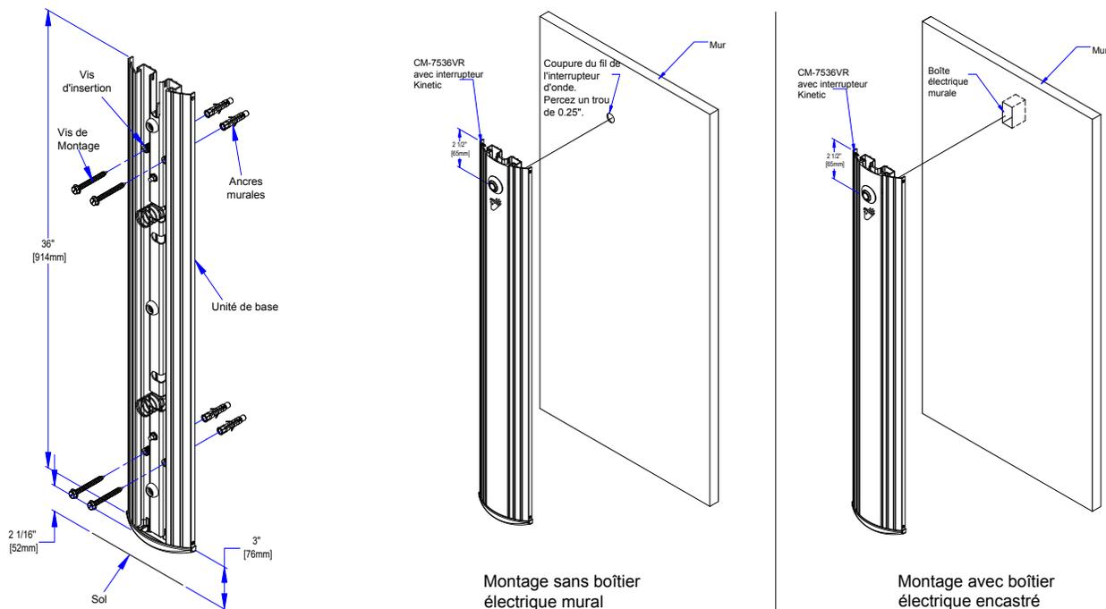
2. Déterminez la hauteur optimale par rapport au sol fini. Voir l'illustration (ci-dessus) pour la hauteur commune. Si vous utilisez une boîte électrique encastrée, centrez l'interrupteur sans contact sur la boîte pour le raccordement des fils, tout en alignant le bord supérieur avec votre marque.
