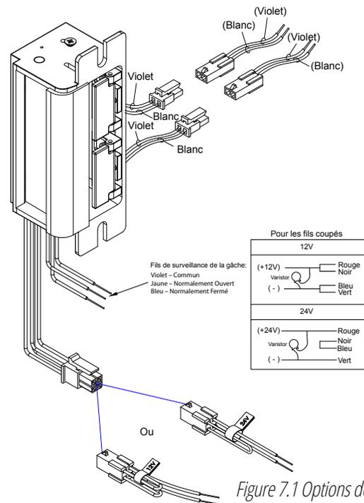
Figure 7.1 Options de connexion de boulon
