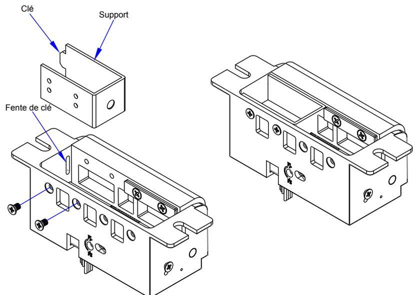
Figure 6.1 Installation du support de verrou mort
