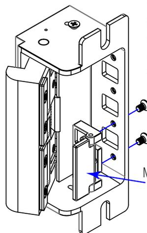
**Remarque:** Les figures 4.1 montrent une installation typique. Le support de verrou mort, peut être monté à des emplacements alternatifs en fonction de l'installation RH ou LH.
