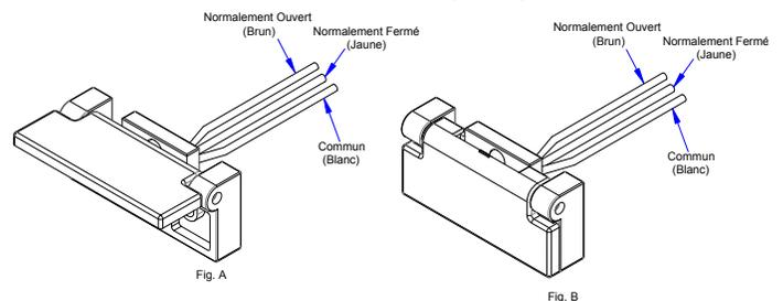
Figure 9.1 Connexion du pêne demi-tour Forme C (optionnel)
